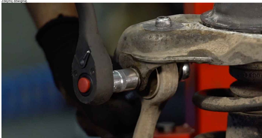
34 Oczyszczyć elementy złącze łączące wahacz z mocowaniem kolumny amortyzatora. Skorzystaj z klucza oczkowego o numerze 16. Skorzystaj z nasadki o numerze #16. Skorzystaj z klucza grzechotkowego.
