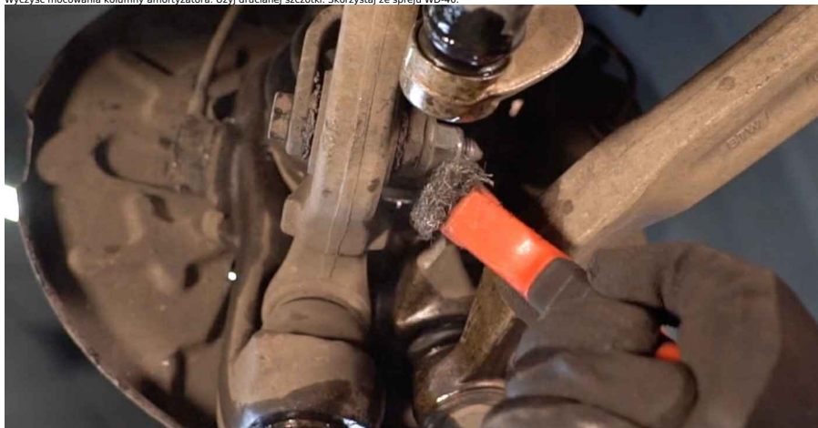
19 Wyczyść mocowania kolumny amortyzatora. Użyj drucianej szczotki. Skorzystaj ze spreju WD-40.
