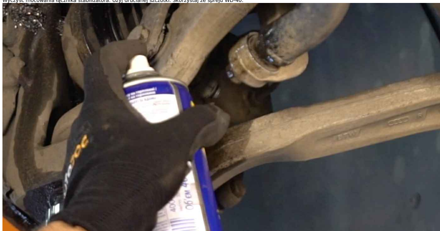
17 Odkręć mocowania łączące łącznik stabilizatora z drążkiem stabilizatora. Skorzystaj z klucza oczkowego o numerze 16. Skorzystaj z nasadki o numerze #16. Skorzystaj z klucza grzechotkowego.
