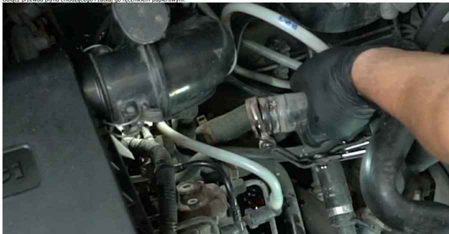
11 Oczyszczyć elementy mocujące pokrywy obudowy termostatu. Użyć drucianej szczotki. Skorzystać z uniwersalnego sprayu do czyszczenia.
