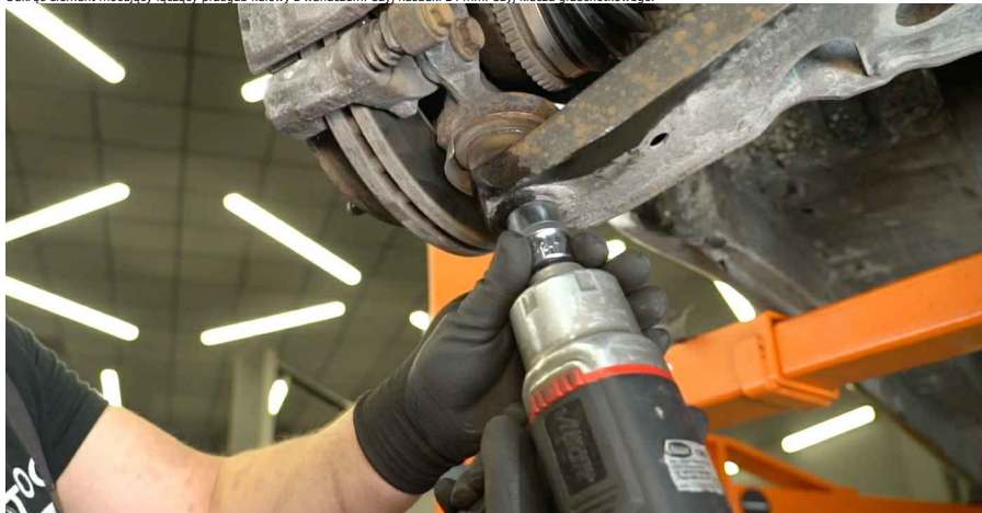
32 Podeprzyj zwrotnicę. Użyj podnośnika do skrzyni biegów lub dodatkowego podnośnika samochodowego.
