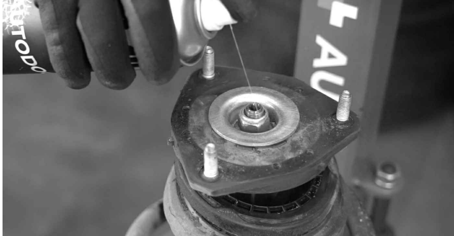
52 Odkręć nakretkę tłoczyska kolumny. Użyj nasadki nakretki kolumny 18 mm. Użyj przedłużki sześciokątnej H6. Użyj klucza grzechotkowego.
