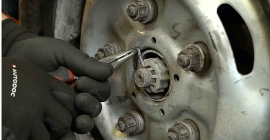
12 Zdejmij nakrętkę koronowa z nakretki osi.
