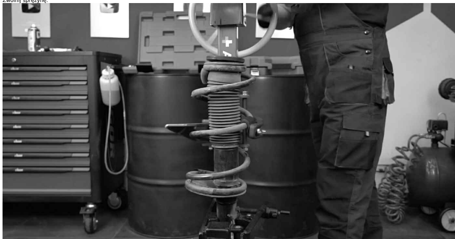
55 Zdemontuj łożysko mocowania i odbójnik.
