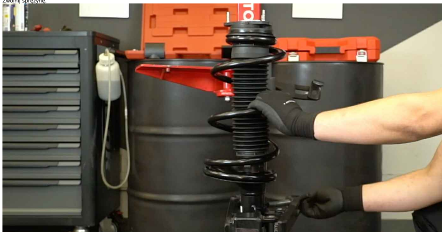
66 Zdejmij zespół kolumny zawieszenia ze ściskacza sprężyn.
