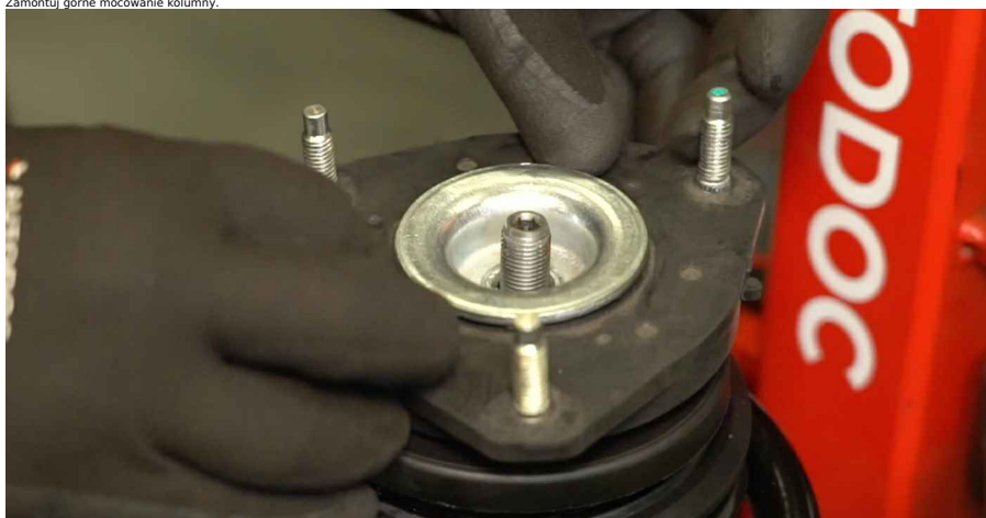
64 Zamontuj i dokręć nakrętkę toczyska kolumny. Użyj nasadki nakrętki kolumny 18 mm. Użyj przedłużki sześciokątnej H6. Użyj klucza dynamometrycznego. Moment dokręcania: 70 N·m.
