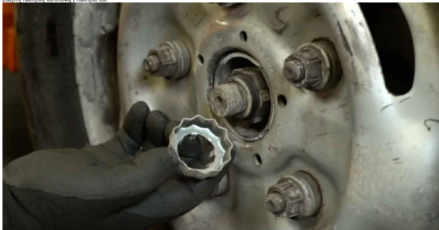
13 Oczyszcz nakrętkę osi. Użyj drucianej szczotki. Użyj sprayu WD-40.
