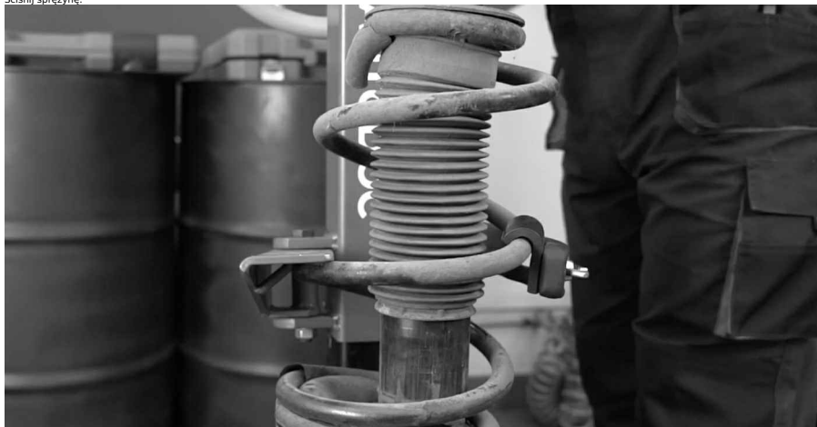
51 Oczyść górną część toczyska kolumny. Użyj drucianej szczotki. Użyj sprayu WD-40.
