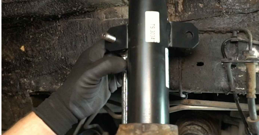
77 Zamontuj wspornik kabla czujnika ABS i wkręć nakrętkę mocującą.
