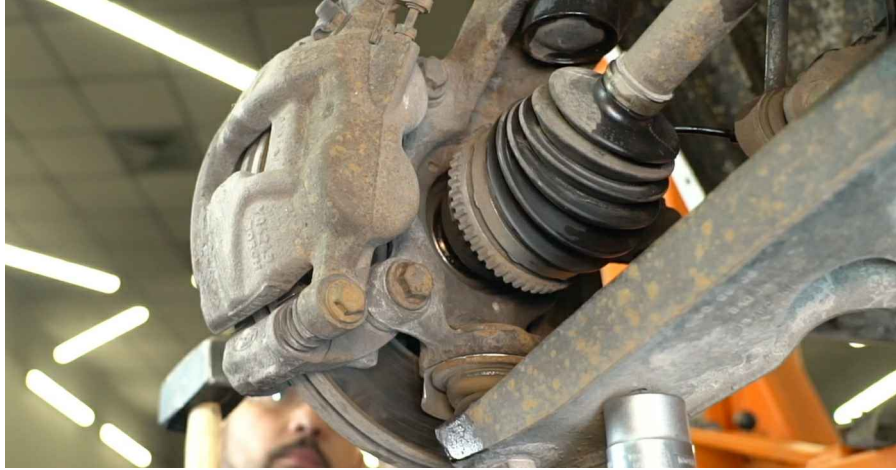
29 Wyjmij podparcie spod wahacza zawieszenia.
