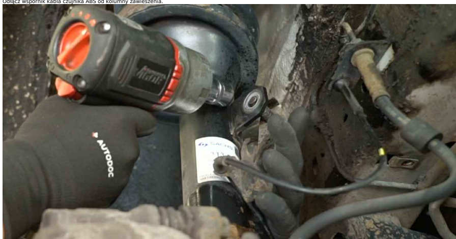
23 Odkręć element mocujący łączący łącznik stabilizatora z kolumną zawieszenia. Użyj klucza płasko-oczkowego 19 mm. Użyj bitu sześciokątnego H5. Użyj klucza grzechotkowego.
