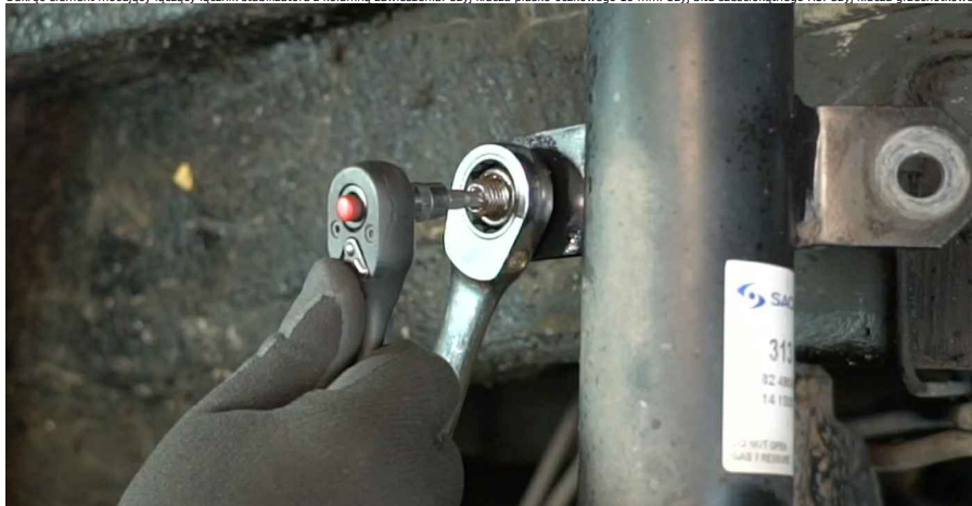
24 Odłącz łącznik stabilizatora od kolumny zawieszenia.
