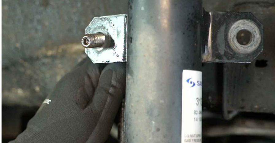
25 Odkręć nakrętkę osi. Użyj nasadki 36 mm. Użyj klucza grzechotkowego.
