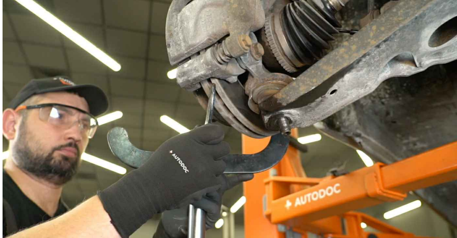
33 Odłącz przegub kulowy od wahacza. Użyj ściągacza do przegubów kulowych. Użyj dźwigni montażowej.
