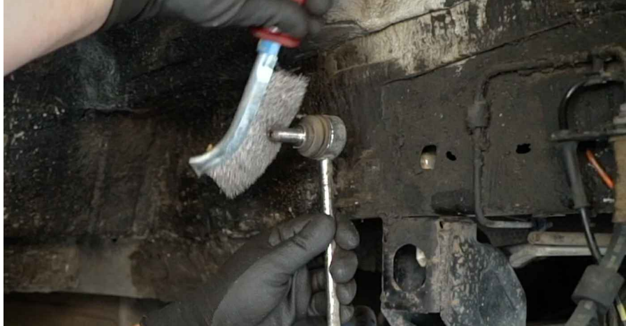
47 Oczyszczyć wypusty przegubu półosi napędowej. Użyć drucianej szczotki. Skorzystać z uniwersalnego sprayu do czyszczenia.
