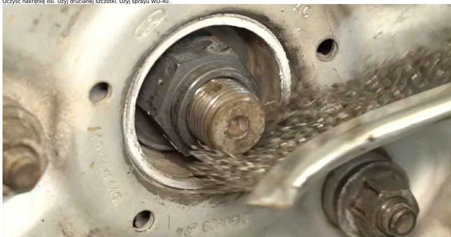
14 Poluzuj nakrętkę osi. Użyj nasadki 36 mm. Użyj pokrętki.
