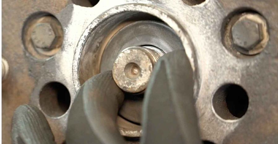
73 Przykręć nakrętkę osi. Użyj nasadki 36 mm. Użyj klucza grzechotkowego.
