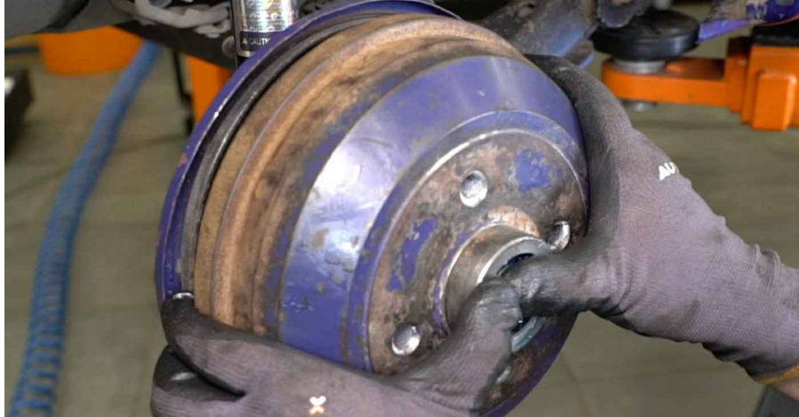
45 Nałóż podkładkę łożyska piasty koła.
