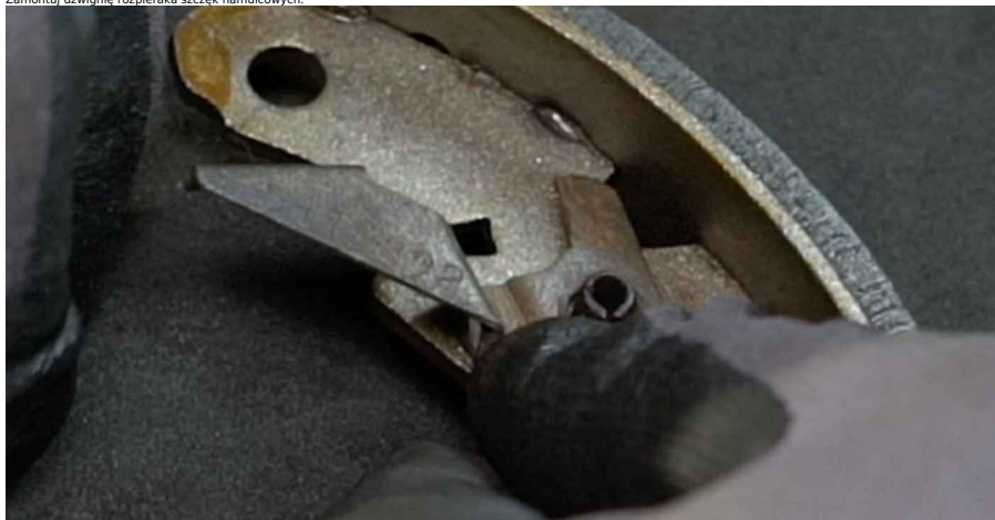
34 Założ pierścień zabezpieczający.
