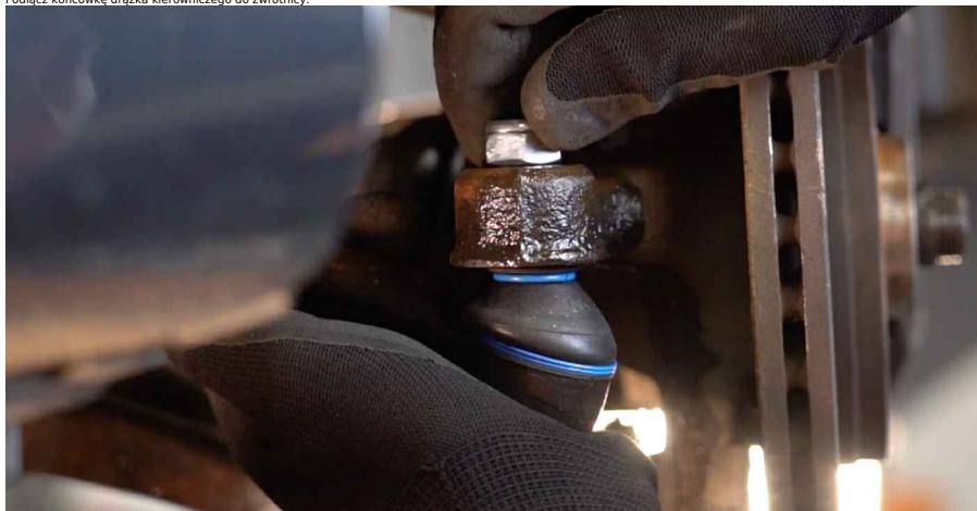
18 Dokręć nakrętkę mocującą końcówkę drążka kierowniczego ze zwrotnicą. Skorzystaj z nasadki o numerze #17. Skorzystaj z klucza dynamometrycznego. Dokręć do go momentu 33 Nm.
