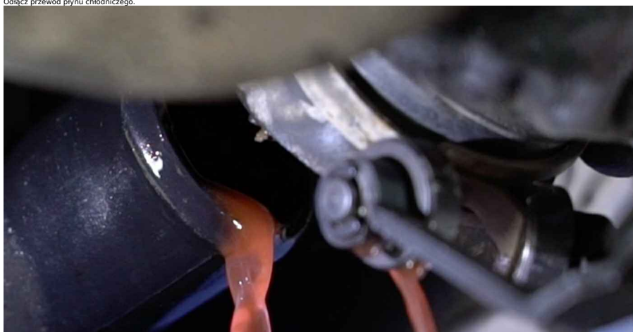
8 Odłącz przewód płynu chłodniczego.
