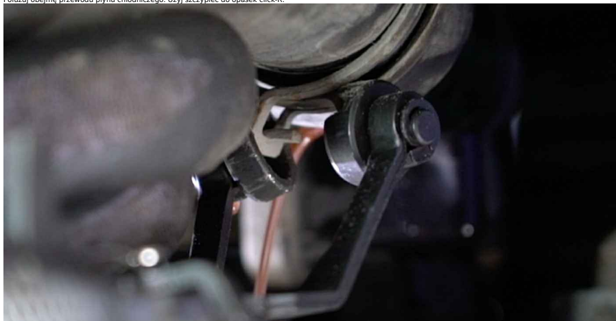
8 Odłącz przewód płynu chłodniczego.
