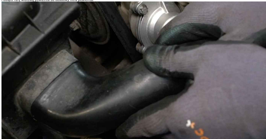
32 Przymocuj spinkę do przewodu doletu filtra powietrza.
