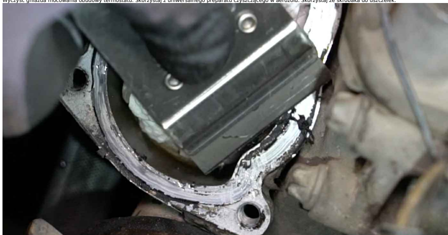
25 Zamontuj obudowę termostatu wraz z termostatem.
