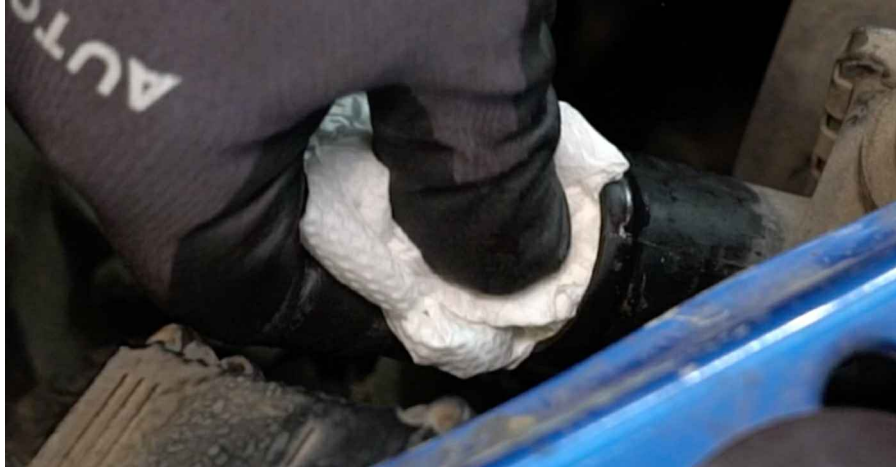
19 Wyczyść obudowę termostatu. Użyj drucianej szczotki. Skorzystaj z uniwersalnego preparatu czyszczącego w aerozolu.
