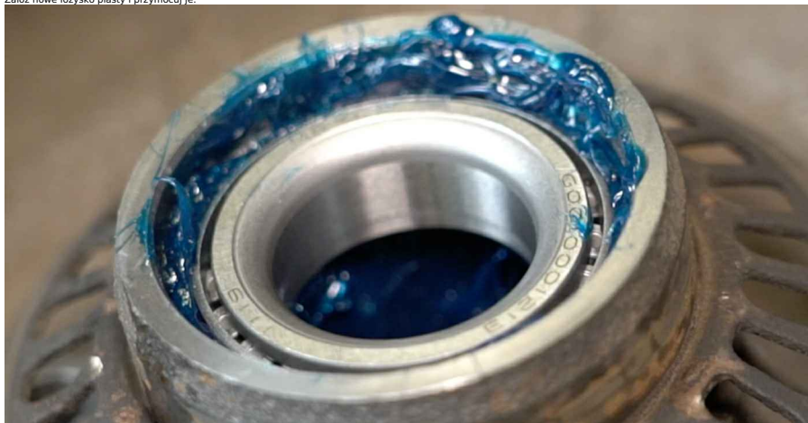
22 Zamontuj uszczelniacz olejowy łożyska koła.
