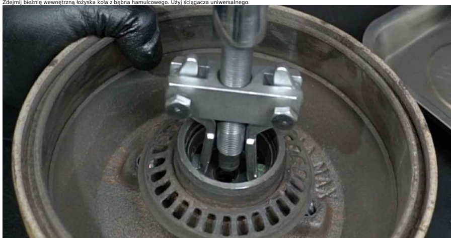
16 Zdejmij zewnętrzną bieżnię łożyska koła z bębna hamulcowego. Użyj zestawu do montażu i demontażu łożysk i tulei.
