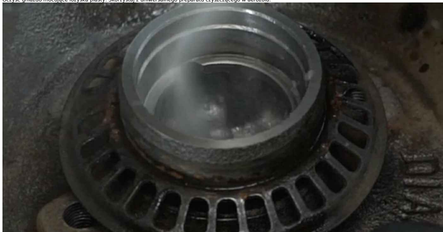
18 Zamontuj nową zewnętrzną bieżnię łożyska koła na bębnie hamulcowym. Zestaw do montażu łożysk i tulei.
