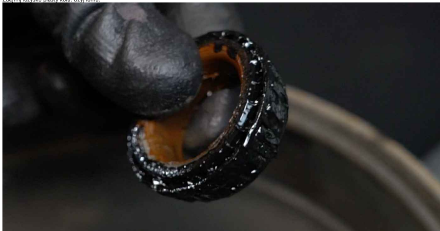
14 Oczyszczyć gniazdo mocujące łożyska piasty.
