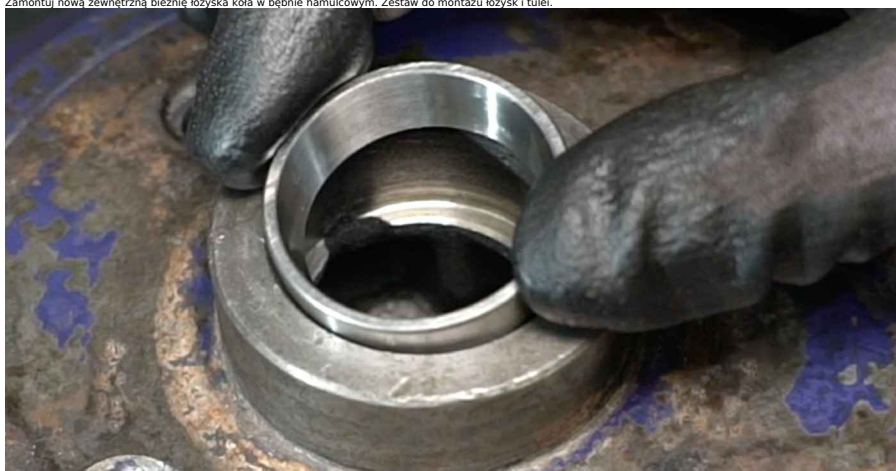
19 Zamontuj nową bieżnię wewnętrzną łożyska koła na bęben hamulcowy. Zestaw do montażu łożysk i tulei.
