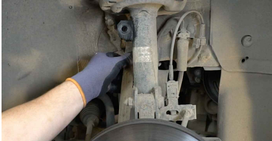
11 Oczyszczyć elementy łączące przewód hamulcowy z kolumną amortyzatora. Użyć drucianej szczotki. Skorzystać ze spreju WD-40.
