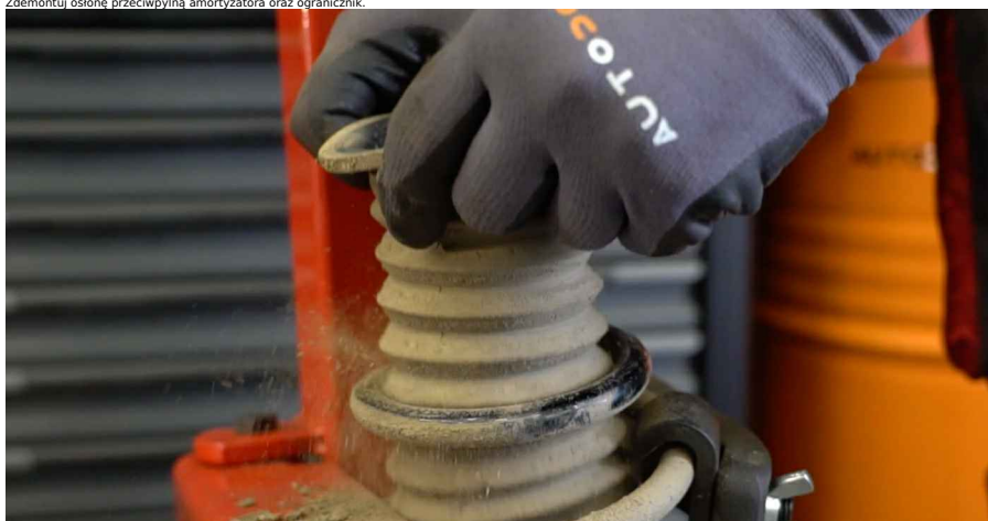
29 Zwolnij sprężynę śrubową.
