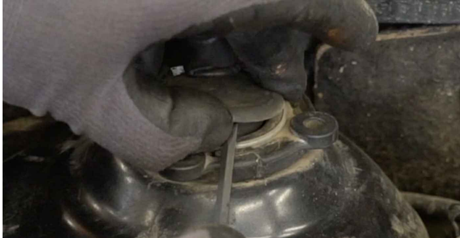
19 Zdejmij uchwyt górnego mocowania kolumny amortyzatora. Skorzystaj z wkrętaka płaskiego.
