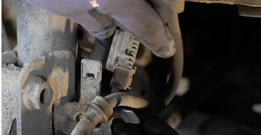
15 Wyczyść mocowania łączące amortyzator ze zwrotnicą. Użyj drucianej szczotki. Skorzystaj ze spreju WD-40.
